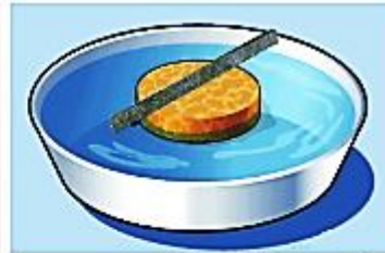
චුම්බක ස්වයංචලයාම හෝ කිරල ඇඟයක රඳවා පලයේ පා කල වීම් හැරෙන දිශාව අනුව ධ්‍රැව හඳුනා ගැනීම
