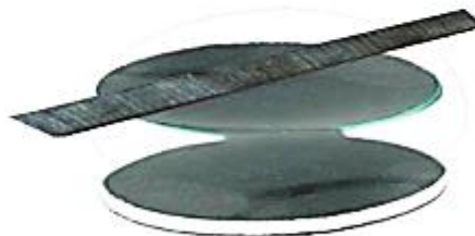
චුම්බක ඔරලෝසු කැටින මත තබා විය තවත් ඔරලෝසු කැටියක් මත තිදෙනෙක් වලක කල වීම් හැරි පවතින දිශාව අනුව ධ්‍රැව හඳුනා ගැනීම
